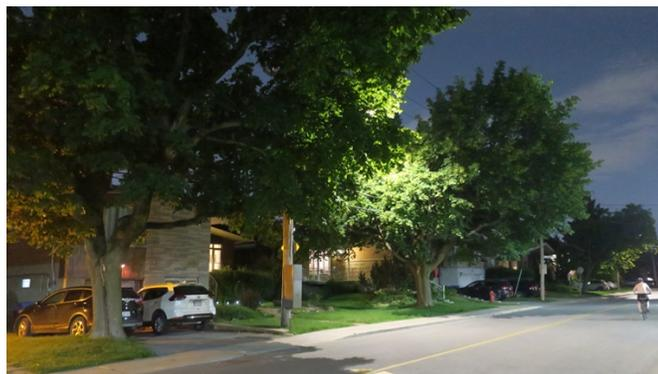
**Figure 8 : Interférence entre l'éclairage et le feuillage des arbres**
