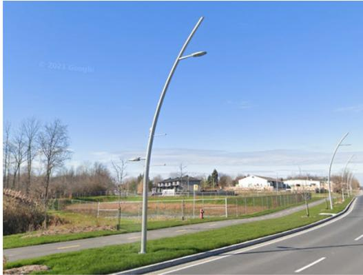
*Figure 76 : Assemblage luminaires de rue et piste multifonctionnelle sur fût unique*
